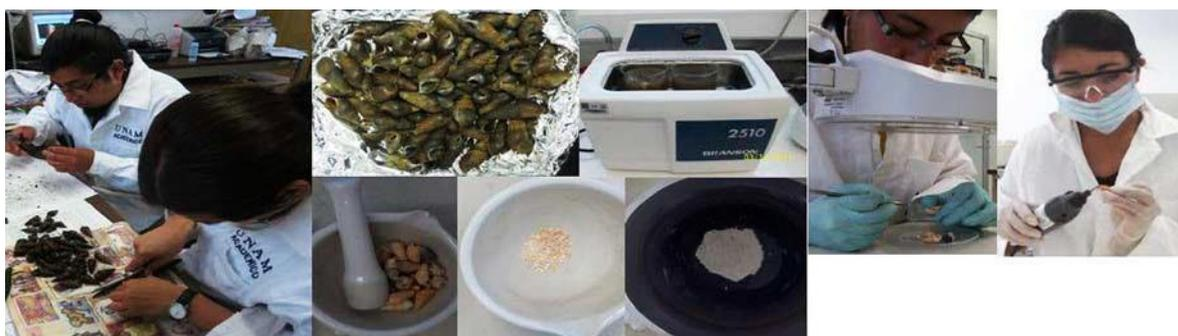
Fig. 5. Imágenes del proceso de preparación de las muestras modernas para el análisis por <sup>14</sup>C.
